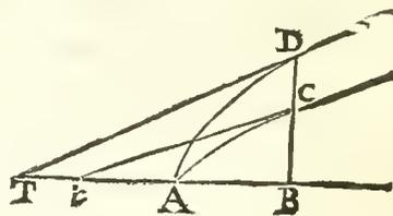
$z$ , comme  $z = y$  à la Courbe AD dont on veut tirer la Tangente ; on aura  $\dot{z} = \dot{y}$ , ainsi  $Ct : Bt :: \dot{y} : \dot{x} :: BD : BT$  ; par le Point T on tirera donc la Tangente DT.
